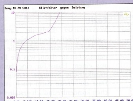
Für eine Röhre sehr gute Klirrwerte, an 4 Ohm steigt die Leistung auf gut 20 Watt pro Kanal
