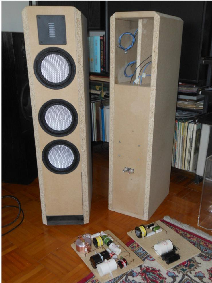
*Die spielfertigen Boxen im Rohbau. Vorne die Filter für Keramix und Keramix3
