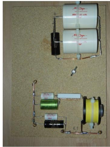
Die Filter: links Keramix, rechts Keramix3; die Sammelschienen laufen in 2 cm Höhe
